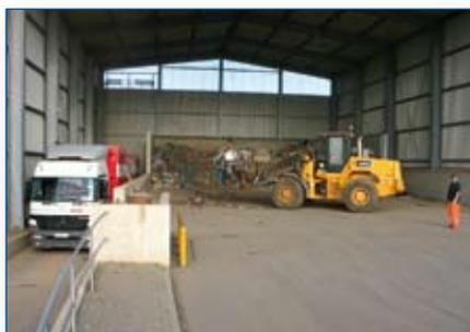
**In der Umladestation Bautzen-Nadelwitz wird mit dem Radlader der LKW mit etwa 20 t Abfall beladen.**
